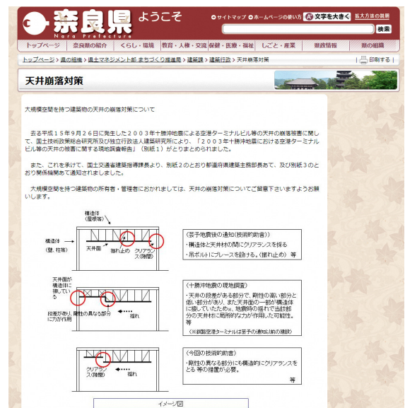
図 4-7 奈良県ホームページ(天井崩落対策)
